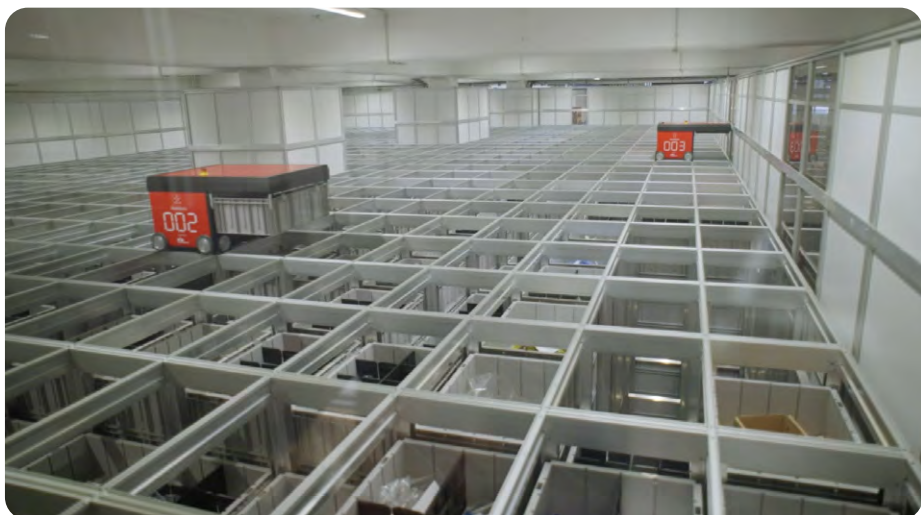
Roboterlager: Die Roboter des AutoStore-Lagersystems bekommen ihre Transportaufträge direkt aus Business Central.
